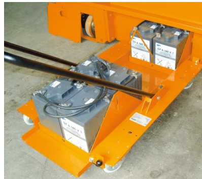
Gerät ist vorbereitet für ein optionales Wechselbatteriesystem Truck is prepared for an optional battery change system
