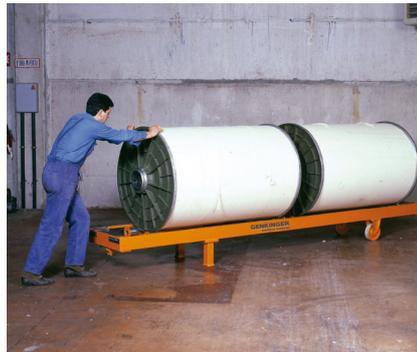
Ausrichten der Teilkettbäume durch Drehen und Verschieben
